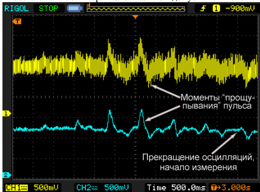
Рисунок 4 - Осциллограммы, отображающие процесс нагнетания давления в манжету Где CH1 - исходный сигнал, демонстрирующий зашумленные компрессором осцилляции в манжете, CH2 - результат фильтрации полезного сигнала.
