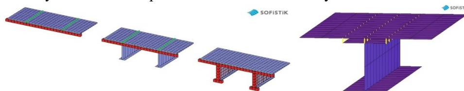
Рис. 6 – Моделирование ребер в виде двутавров МКЭ Fig. 6 – Modeling of ribs in the form of I-beams using FEM
