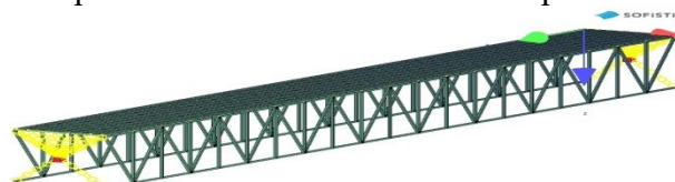
Рис. 8 – Моделирование ребер в виде фермы МКЭ Fig. 8 – Modeling of ribs in the form of a truss using FEM
