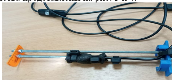
Рис. 3 - Устройство для измерения толщины намороженного слоя льда во время проведения эксперимента
