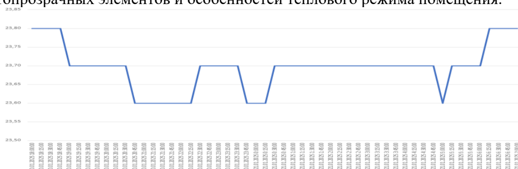
Рис. 2 – Значение температуры внутреннего воздуха в учебном классе по датчику № 1 Fig. 2 – The indoor air temperature reading in the classroom according to sensor No. 1
