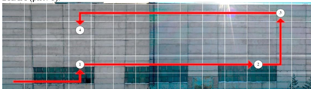
Рис. 1 – Пример построения полётной карты с помощью модуля визуализации в приложении «ММК БВС-ОПО»
