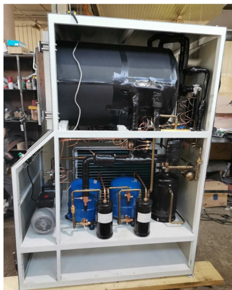
Рис. 3 – Сублиматор серии ВСГ. Снята декоративная правая панель.
