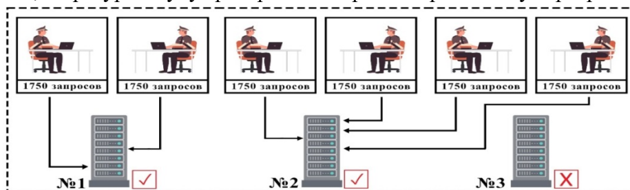
Рис. 5 – Схема балансировки нагрузки при аварийной работе информационной системы
