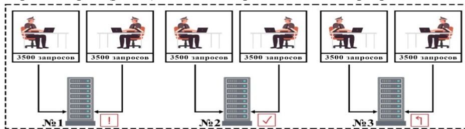
Рис. 3 – Схема работы распределенной информационной системы без балансировки нагрузки
