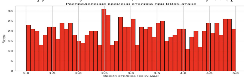
Рис. 3 – Распределение времени отклика при DDoS-атаке Fig. 3 – Distribution of response time during a DDoS attack
