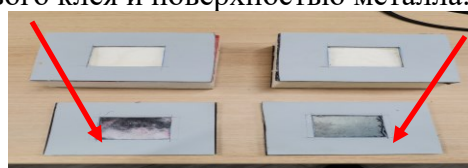
Рис. 6 - а) пример испытательных образцов для выполнения адгезионного отрыва; б) один из показателей прочности адгезионного отрыва от поверхности обработанного металла Fig. 6 - a) example of test samples for performing adhesive separation; b) one of the indicators of the strength of adhesive separation from the surface of the processed metal
