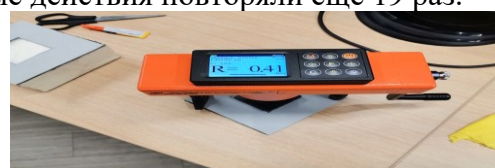
Рис. 6 - а) пример испытательных образцов для выполнения адгезионного отрыва; б) один из показателей прочности адгезионного отрыва от поверхности обработанного металла Fig. 6 - a) example of test samples for performing adhesive separation; b) one of the indicators of the strength of adhesive separation from the surface of the processed metal
