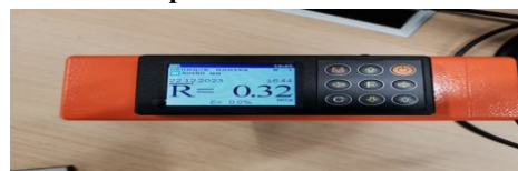
Рис. 7 - а) поверхность обработанного металла после выполнения адгезионного отрыва (видна фосфатная пленка); б) один из показателей прочности адгезионного отрыва от поверхности необработанного металла с «застарелой» коррозией Fig. 7 - a) surface of treated metal after adhesive tear-off (phosphate film is visible); b) one of the indicators of adhesive tear-off strength from the surface of untreated metal with "old" corrosion
