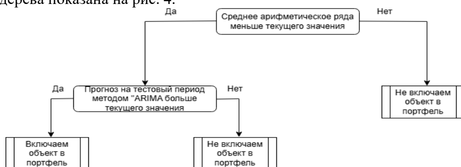
Рис. 4 - Разработанное дерево решений Fig. 4 - Developed decision tree
