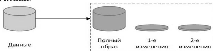
**Рис. 7 – Алгоритм инкрементального резервного копирования**
