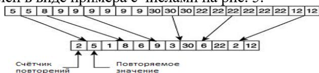
Рис. 5 – Принцип алгоритма RLE на примере последовательности чисел
