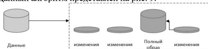
**Рис. 9 – Алгоритм реверсивного инкрементального резервного копирования**
