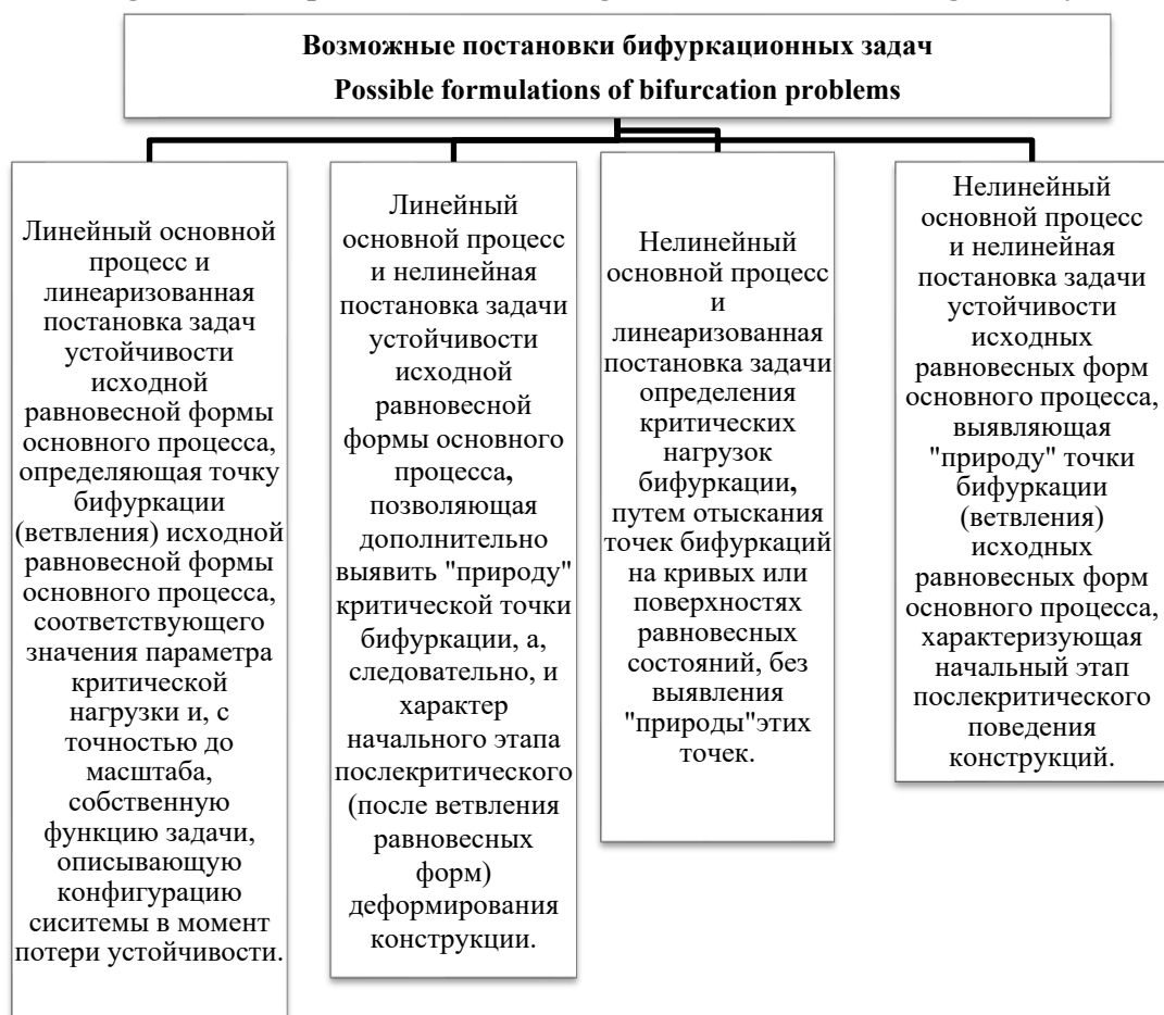
Рис. 3. Возможные постановки бифуркационных задач Fig. 3. Possible formulations of bifurcation problems
