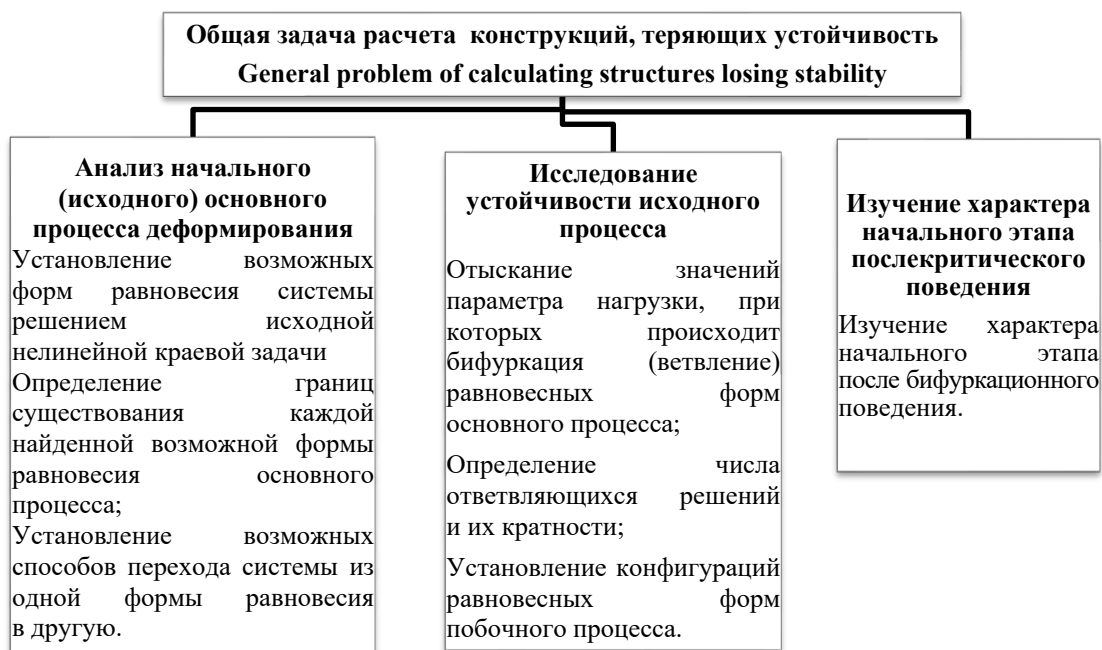
Рис. 2. Общая задача расчета конструкций, теряющих устойчивость Fig. 2. General problem of calculating structures that are losing stability
