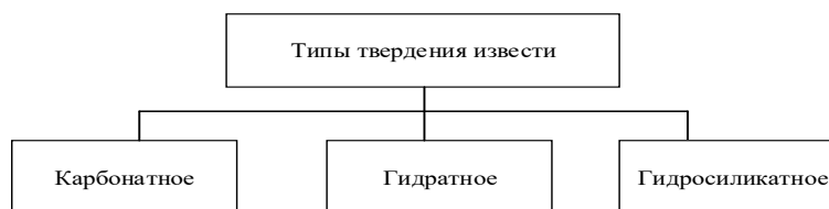
Рис. 3. Типы твердения известкового вяжущего Fig. 3. Types of hardening of lime binder
