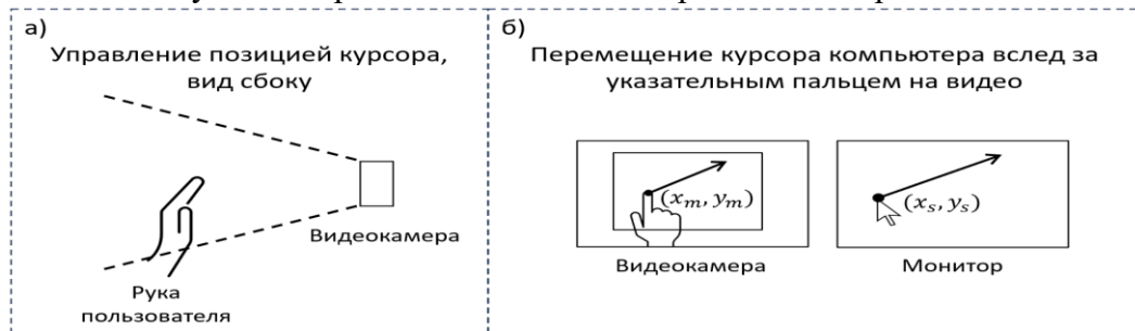
Рис. 1. а) управление координатами курсора с помощью видеокамеры, вид сбоку; б) слева – кадр с видеокамеры, управляющий объект – ногтевая фаланга указательного пальца, вид спереди, справа – монитор пользователя
