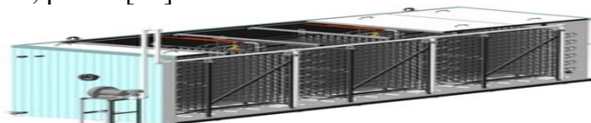
Рис. 1. Общий вид льдоаккумулятора компании Орелхолодмаш [11]
