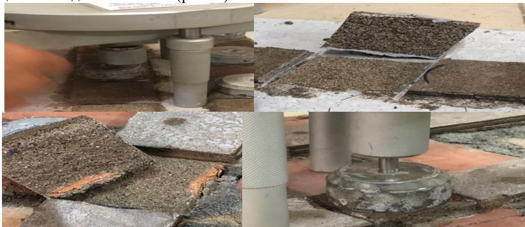
Рис. 2. Фрагмент испытаний на адгезионную прочность
