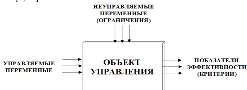
Рис. 1. Обобщенная структурная модель объекта управления
