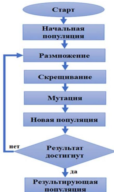
**Рис. 2. Блок-схема генетического алгоритма**
