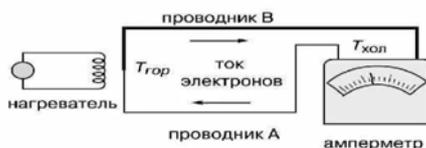
**Рис. 3. Схема работы эффекта Зеебека**
