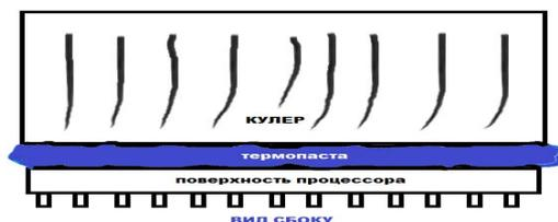
**Рис.1. Схема работы термопасты**
