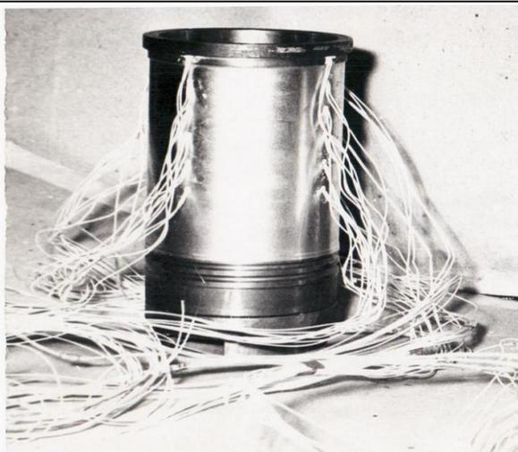
Рисунок 1 - Препарированная цилиндрическая втулка
