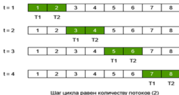
Рис. 5. Доступ к данным при шаге, равном количеству потоков
