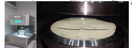
Рис. 3.a) Общий вид испытательной установки; б) Образец мембраны LOGICBASE™V-SL сразу после проведения испытания
