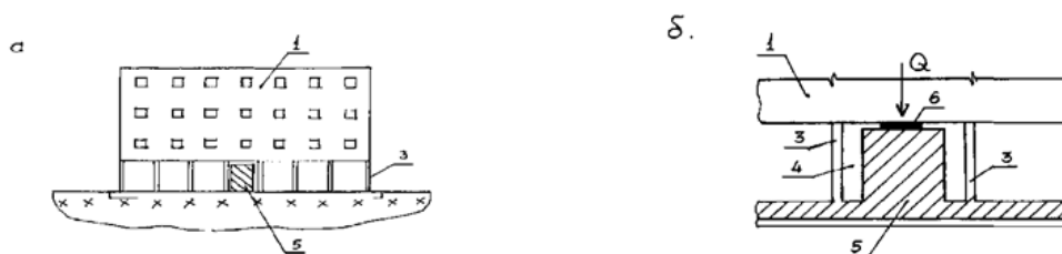
Рис. 4. Здание на гибких колоннах:
