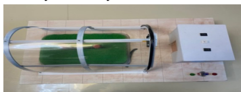
Рис. 10. Макет теплицы с автоматизированной системой управления
