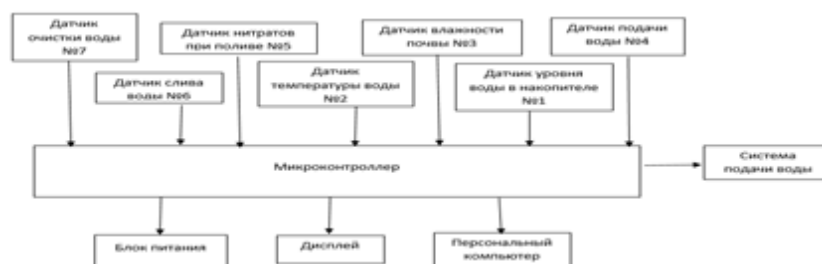
Рис.3. Структурная схема автоматического контроля и управления системы полива Fig.3. Block diagram of automatic control and management of the irrigation system
