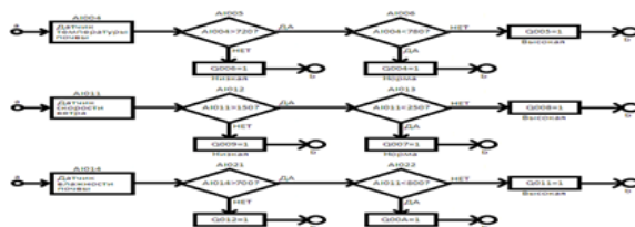
Рис.5. Блок-схемы алгоритма работы датчиков температуры воздуха, скорости ветра и влажности почвы
