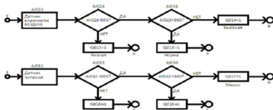
Рис.7. Блок-схемы работы датчиков питания и влажности воздуха
