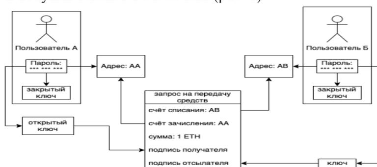
**Рис. 1. Схема процесса платёжного оборота в децентрализованной сети**
