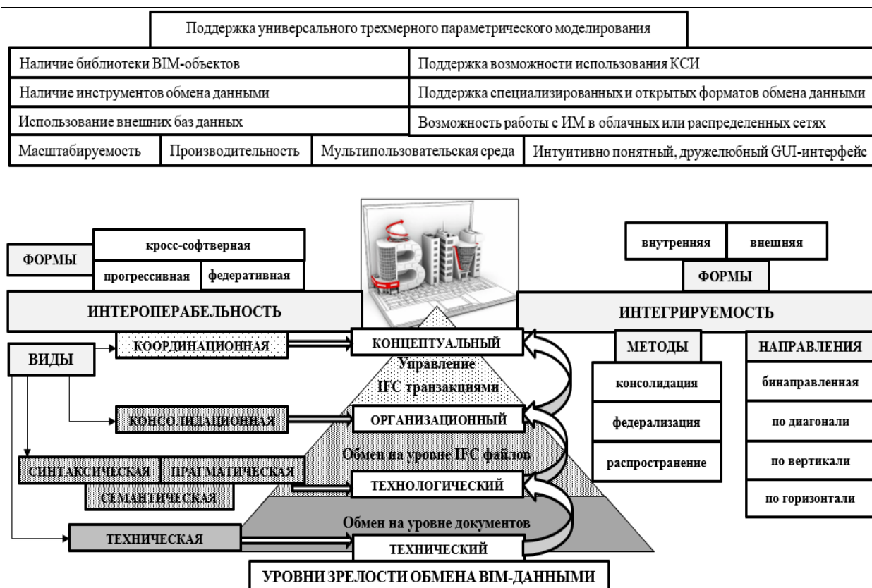
Рис. 2. Ключевые параметры отнесения программного продукта к BIM-решениям* Fig. 2. Key parameters for classifying a software product as a BIM solution
