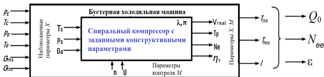
Рис. 2. Параметры взаимодействия ХМ с внешней средой и взаимосвязь с параметрами и характеристиками СПК
