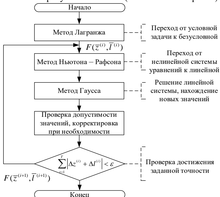
Рис.1. Алгоритм применения численных методов в математической модели нахождения равновесного состава термодинамической системы
