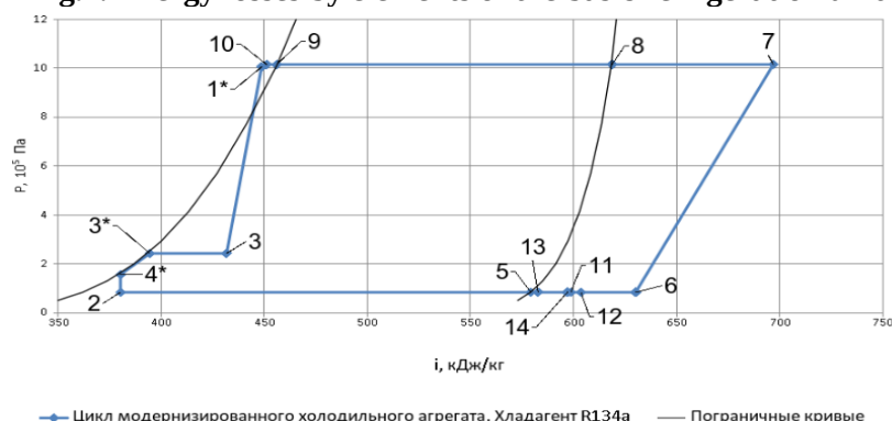
Рис.3. Теоретический цикл модернизированного холодильного агрегата в P-I диаграмме. T_0 = -30^\circ\text{C} , T_{oc} = 32^\circ\text{C} , T_k = 40^\circ\text{C}
