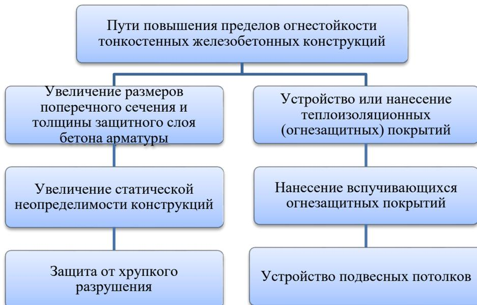
**Рис. 1. Пути повышения пределов огнестойкости тонкостенных железобетонных конструкций**
