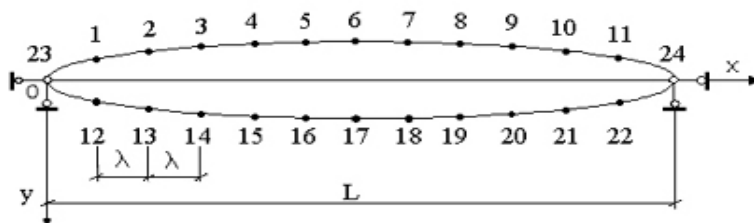
Рис. 2. Расчетная схема однопролетной линзообразной мембранно-пневматической системы (составлено авторами)
