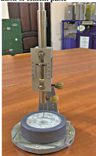
**Определение нормальной плотности цементного теста и сроков схватывания**
