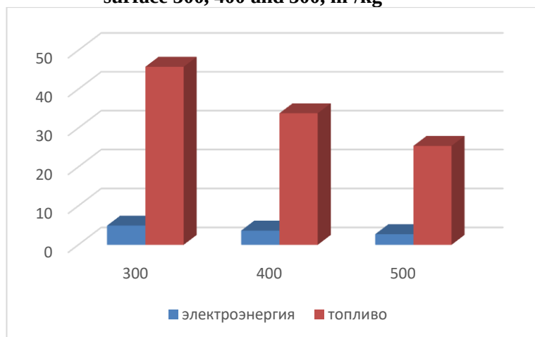
Рис. 4. Расход энергии, кг у.т. на 1 м 3 бетона В20 при использовании шлакопортландцемента удельной поверхности 300, 400 и 500, м 2 /кг
