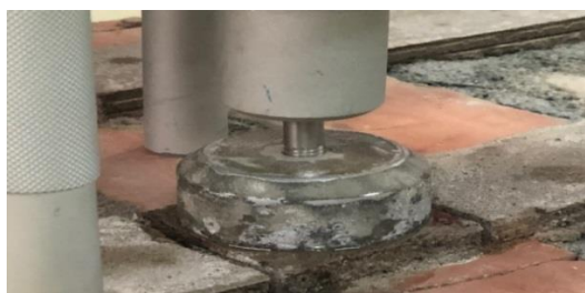
Рис. 3. Проведение испытаний на отрыв раствора от кирпичной стены Fig. 3. Conducting tests for the separation of mortar from a brick wall
