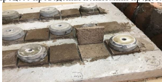
Рис. 2. Проведение испытаний на отрыв раствора от бетонного основания Fig. 2. Conducting tests for the separation of the solution from the concrete base
