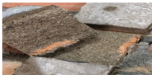
Рис. 3. Проведение испытаний на отрыв раствора от кирпичной стены Fig. 3. Conducting tests for the separation of mortar from a brick wall
