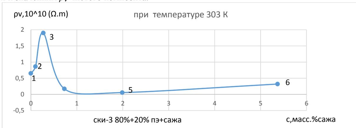
**Рис.5. Концентрационные зависимости удельного объемного электрического сопротивления для композита 80% СКИ-3 + 20% ПЭНП + сажа**
